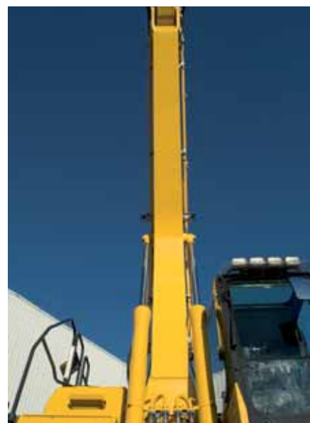
Ściany wyciągnika z jednego kawałka blachy
